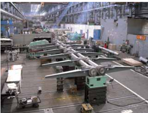
Этап изготовления кантователя для модернизации линии прокатного стана ОАО «Ашинский металлургический завод»
