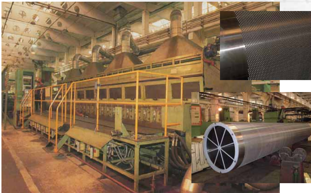
Специальный 162-шпindelный сверлильный станок итальянской фирмы «Сафон» для обработки пушечными сверлами диаметром 5, 6, 8 мм рубашек отсасывающих валов диаметром до 1900 мм и длиной до 10 000 мм
