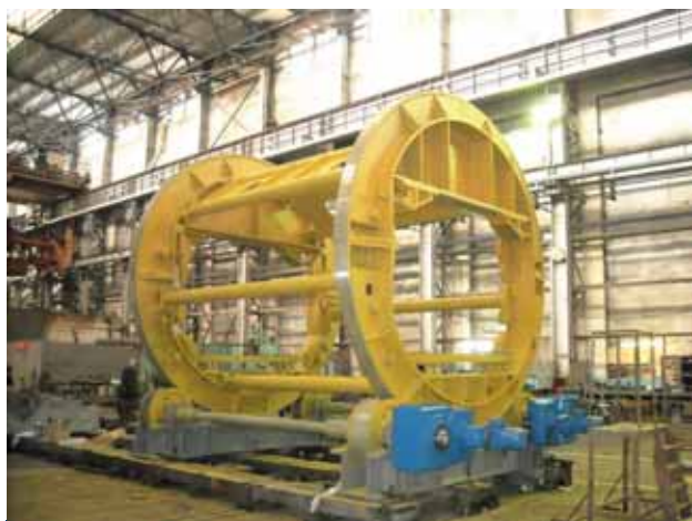
Кантователь верхних кассет правильных машин по заказу ЗАО «НПП «Машпром»
