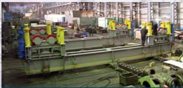
Изготовление блока механизма перемещения мобильной буровой установки
