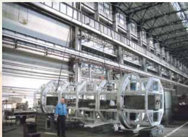
Этап изготовления рольганга кантующего по заказу ЗАО «НПП «Машпром». Установлен на заводе Корпорации
