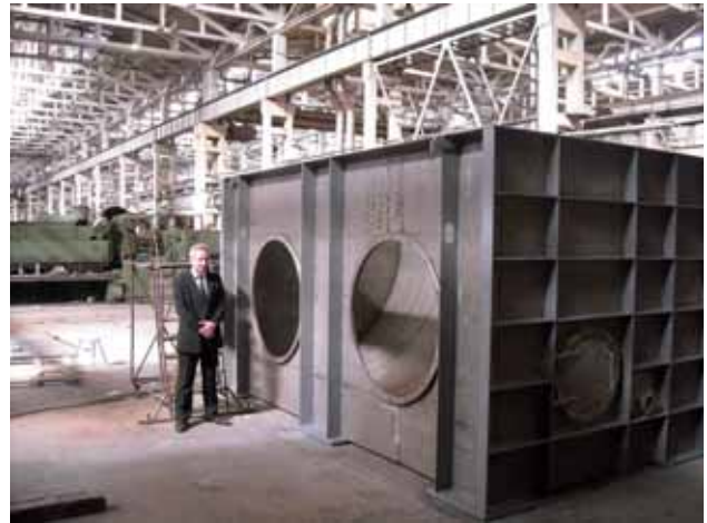
Ванна установки переработки брака под клеильным прессом для ООО «Уралбумага»
