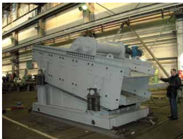
Грохот для разделения дробленого шлака на фракции. Установлен в технологической линии участка переработки отвалных шлаков на ОАО «НТМК»
