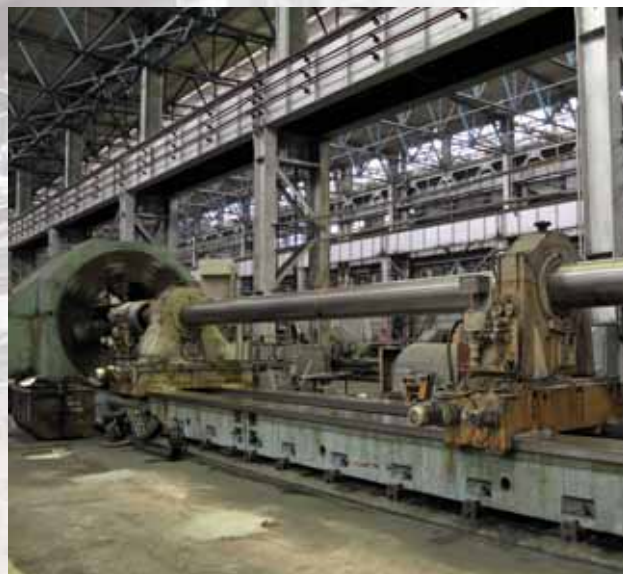
Специальный глубокорасточный станок КЖ1947Ф1 позволяет растачивать отверстия диаметром до 1500 мм и длиной до 12000 мм
