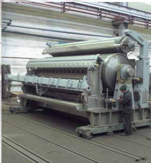
Вакуум-формующее устройство в составе картоноделательной машины для Пермского ЦБК
