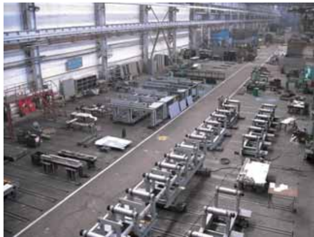
Этап изготовления рольганга в составе транспортной системы МНЛЗ сталеплавильного комплекса ОАО «Ижсталь»
